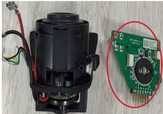
24. Retirer l'assemblage de circuits imprimés (PCBA) du bouton
