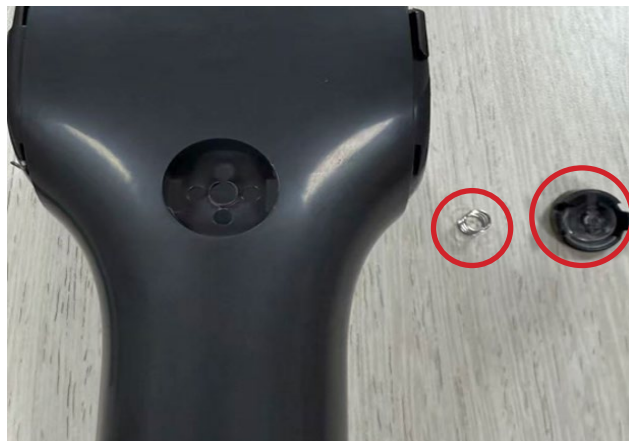
34. Retirer le couvercle du crochet
