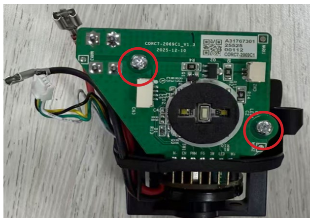
24. Retirer l'assemblage de circuits imprimés (PCBA) du bouton
