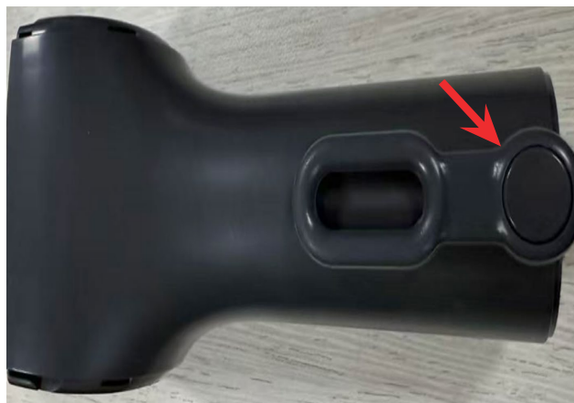
34. Retirer le couvercle du crochet
