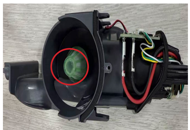
18. Retirer le cadre de la grille du filtre
