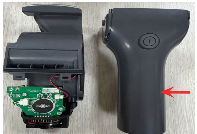
18. Retirer le cadre de la grille du filtre
